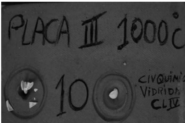
Figura 4 - Aspecto calcinado do ionômero de vidro Vidrion à temperatura de 1.000 °C
