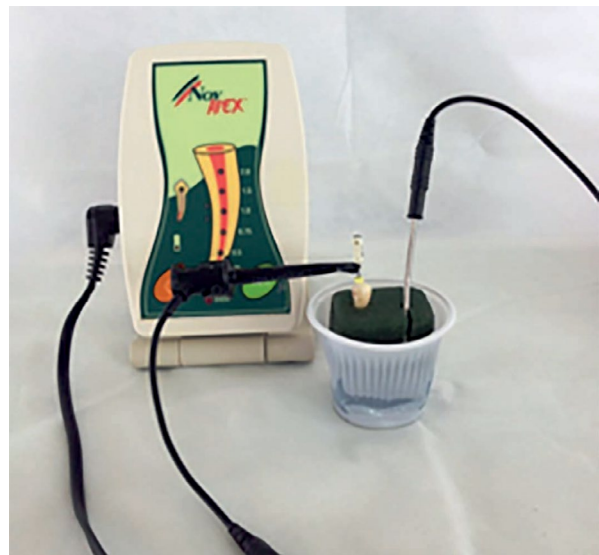
Figura 3 – Base experimental com elemento dental e alça labial posicionados para medição eletrônica no Novapex
