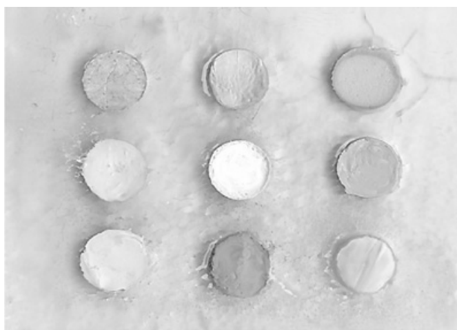
Figura 1. Placa de acrílico com os corpos de prova a serem radiografados.
