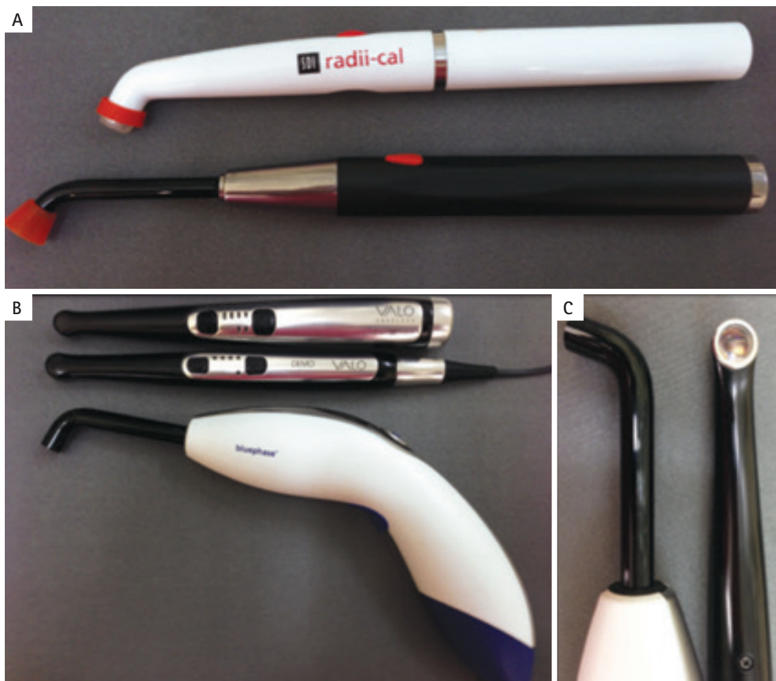
Aparelhos fotopolimerizadores LEDs. A – LED's com chips na ponta (radii-cal) e outro no meio com ponteira de fibra ótica (Translux Power Blue). B e C – VALO e Bluephase G2 aparelhos com chips emissores de luz azul e um emissor de luz violeta
