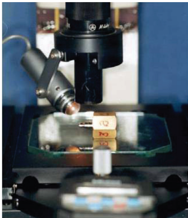
Figura 6 - Leitura da adaptação vertical de um cilindro em microscópio óptico.
