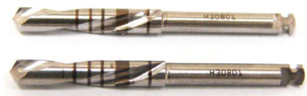
Figura 4 - Amostras após ensaio de resistência à esterilização em autoclave.
