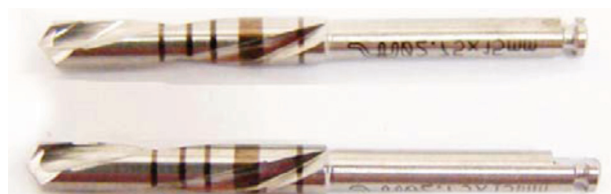
Figura 5 - Amostras após ensaio de resistência à corrosão em água em ebulição.
