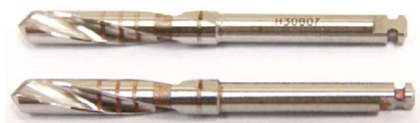
Figura 6 - Amostras após ensaio de resistência à corrosão em sulfato de cobre.
