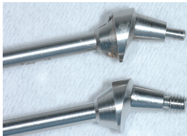
Figura 6 - Em (a) observa-se o intermediário após a falha e, em (b) nota-se um intermediário íntegro.
