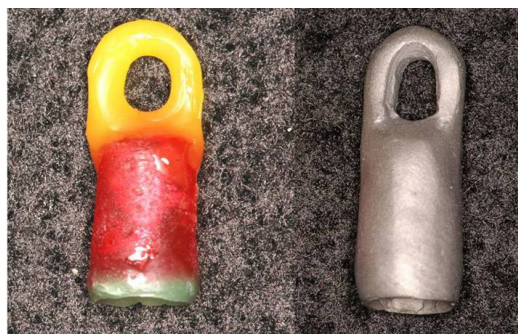
Figura 2 - Um padrão em cera/resina pronto e uma coroa fundida com uma liga de NiCr.
