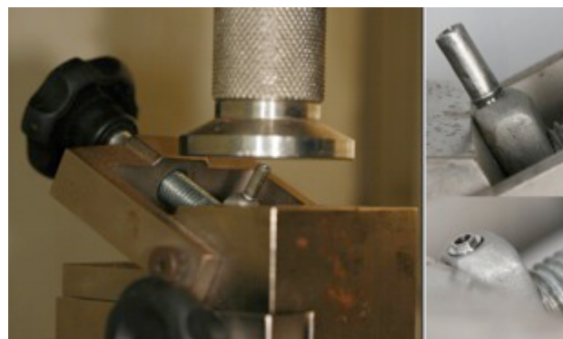
Figura 3 - Montagem experimental para ensaio de resistência ao carregamento oblíquo (45 °C) 3 .
