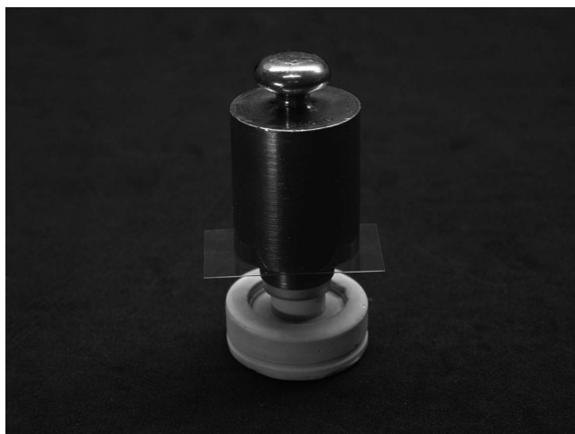
Figura 5 - Compactação da resina composta indireta
