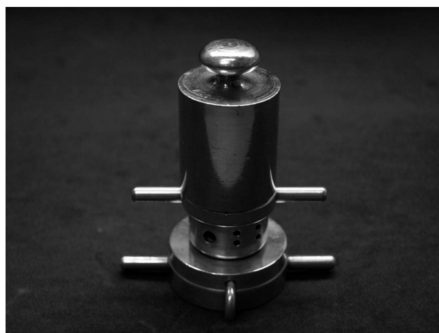
Figura 3 - Moldeira em posição, adaptada à base de latão e peso de 200g
