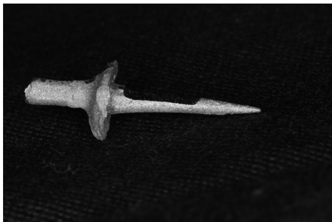
Figura 1 – Pino do retentor intrarradicular após o desgaste de 0,2 mm.
