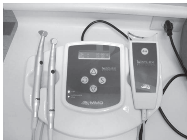
Figura 5 - Equipamento Twinflex evolution, MM optics.
