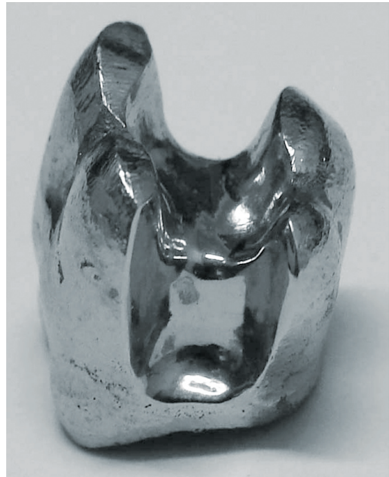
Figura 1 – Fotografia do modelo mestre fundido em liga de níquel-cromo
